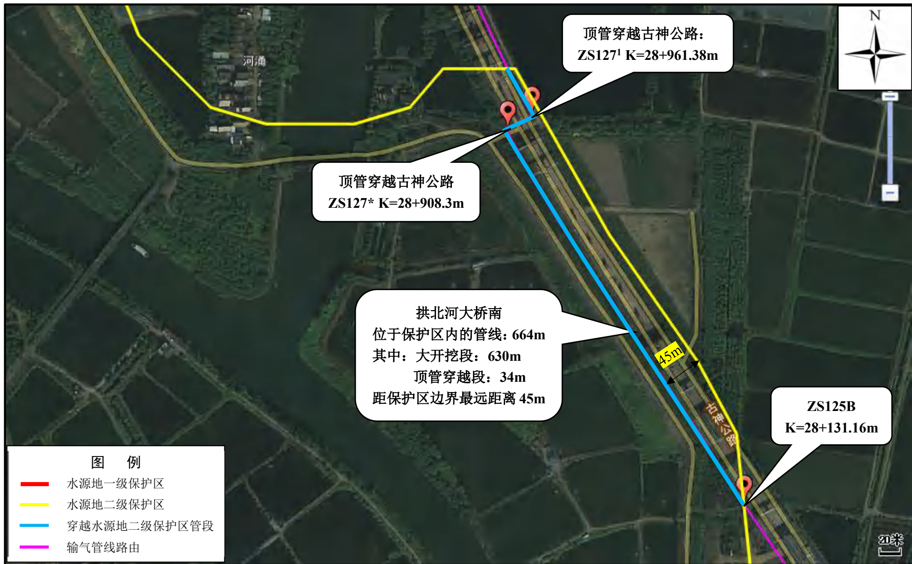
附图 8-3 输气管线与全禄水厂水源保护区位置关系图（拱北河大桥南）
