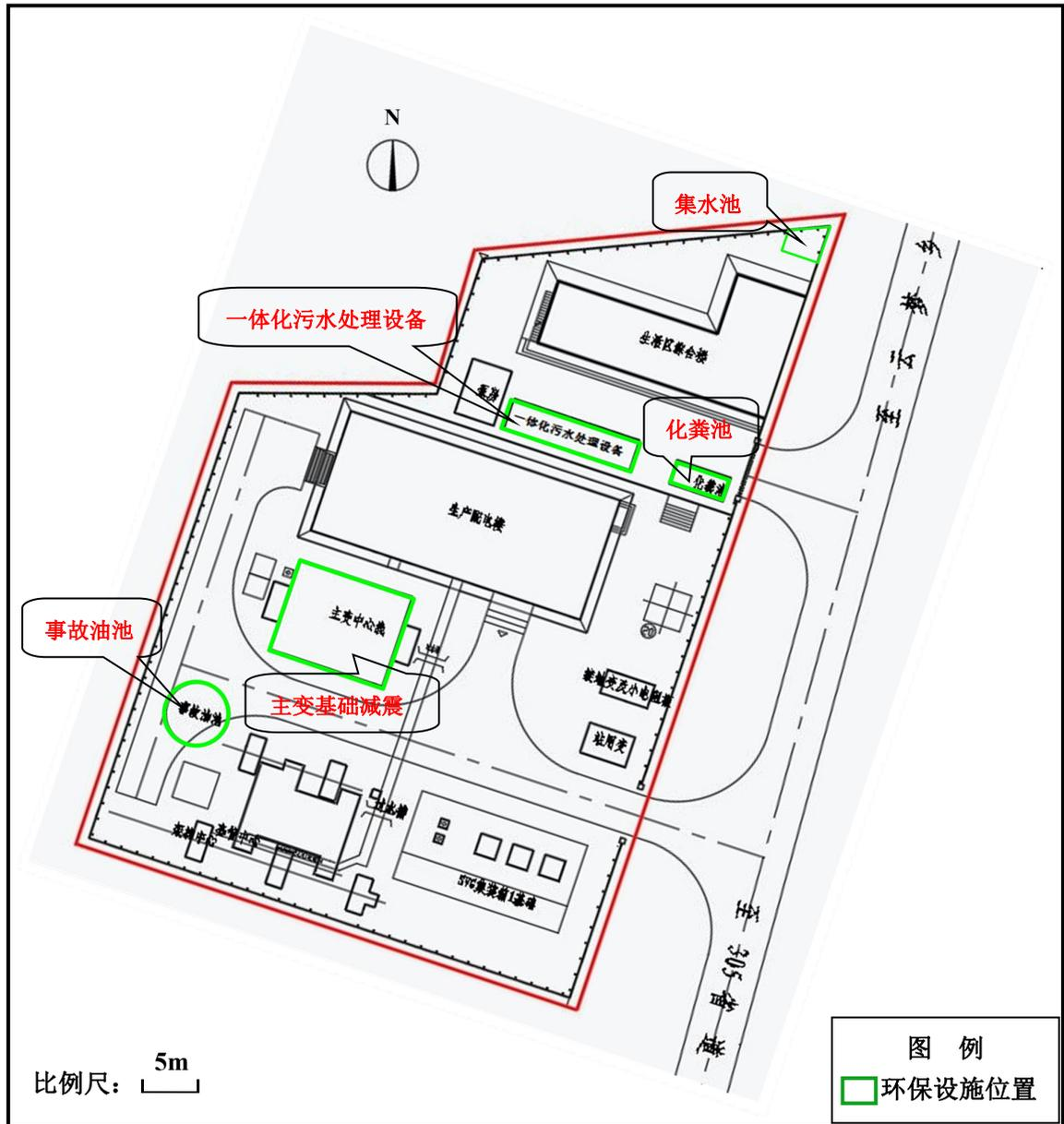
图 4-3 110kV 西塔光伏电站平面布置图
