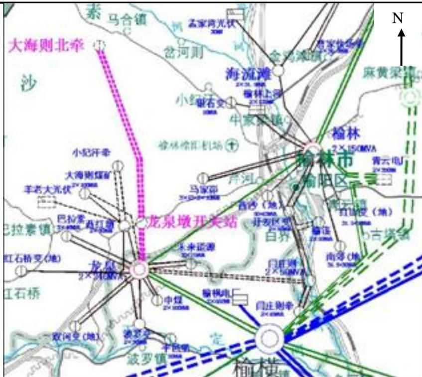
图 1-2 新建龙泉墩 110kV 开关站及大海则北牵地理接线图
