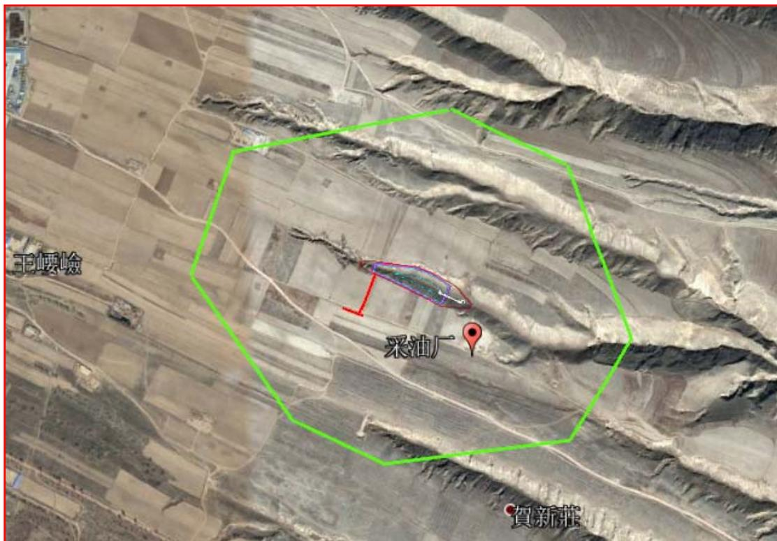
图 5-3 项目垃圾填埋场防护距离包络线图
