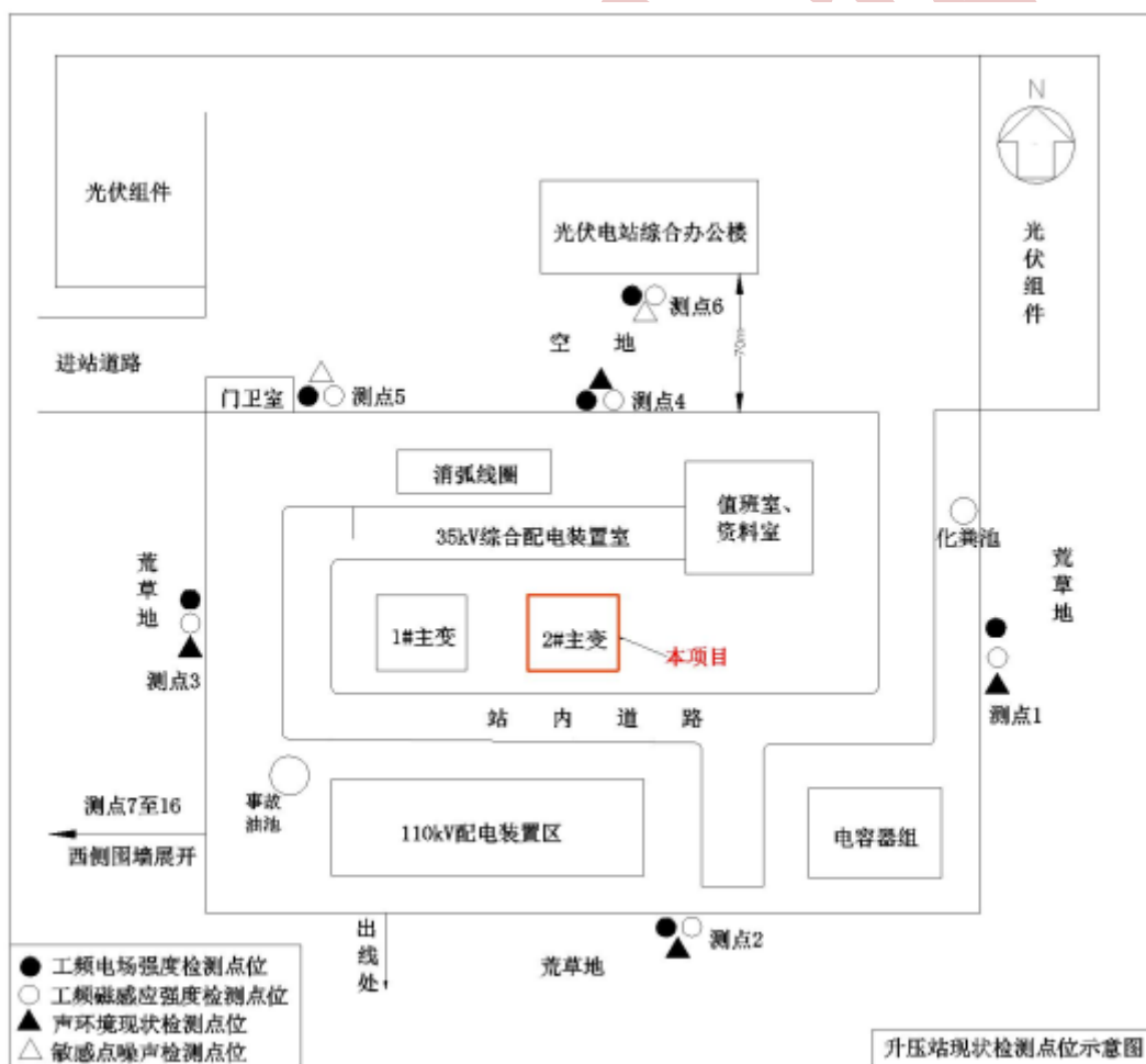
图 6.2-1 110kV 升压站类比监测点位示意图
