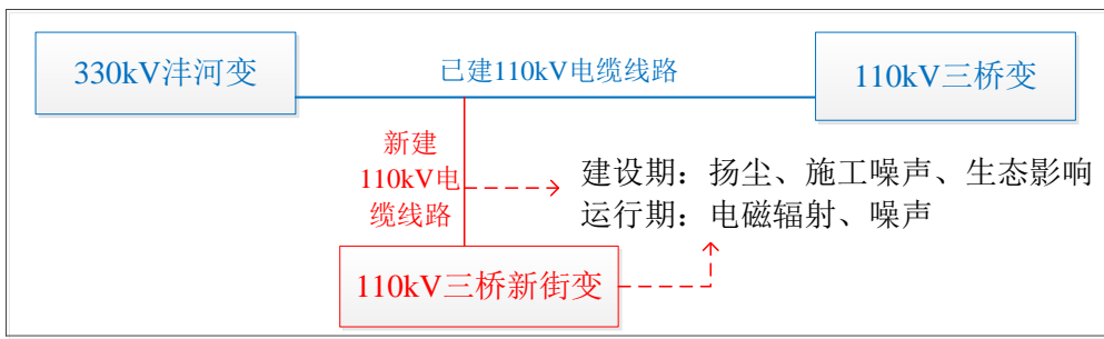
图 4-5 电缆线路工艺流程及产污环节示意图
