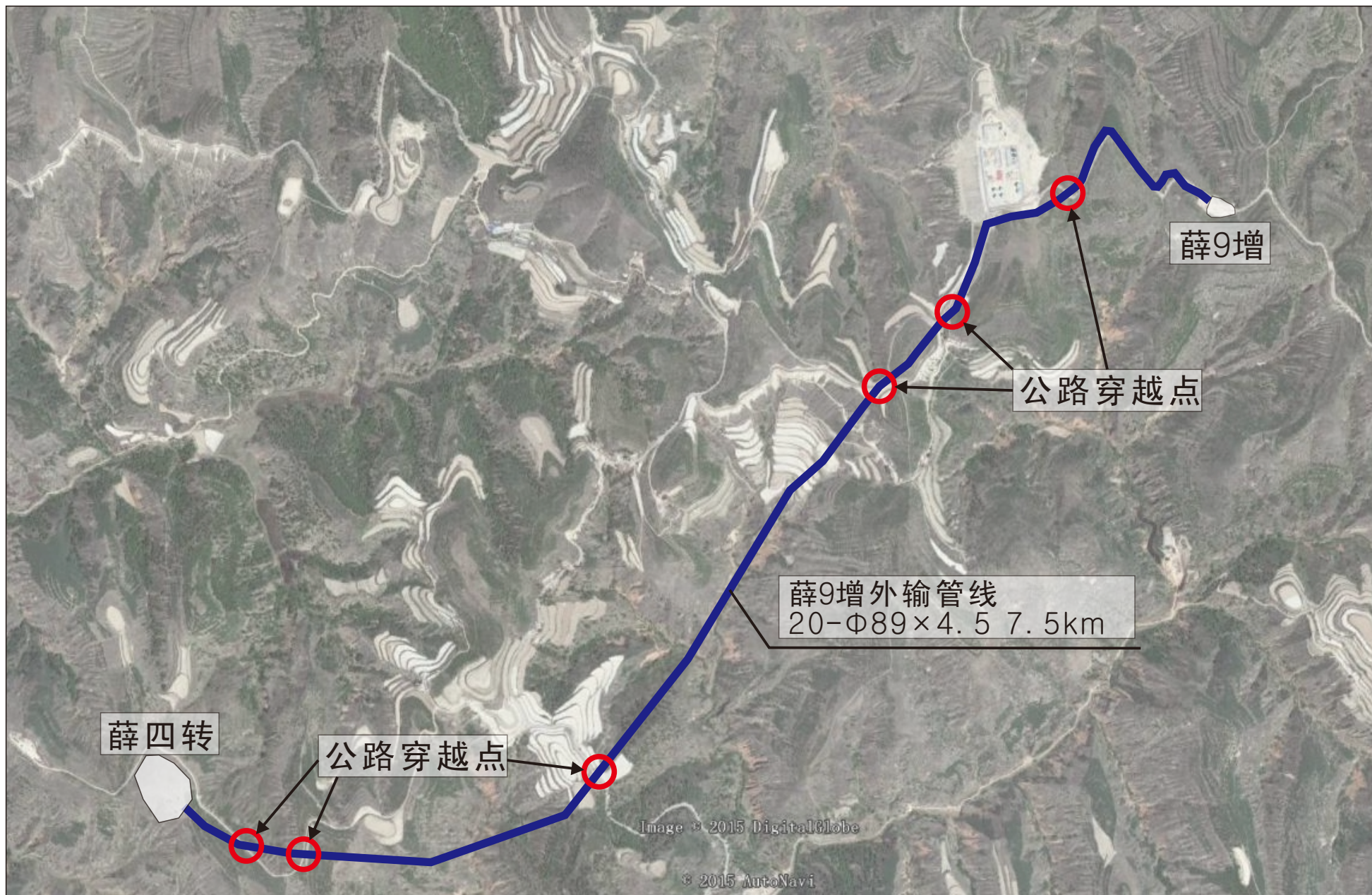
图2 薛9增外输管线走向及周边环境关系示意图
