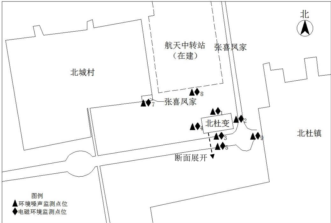
图7-1 北杜110kV变电站监测点位示意图
